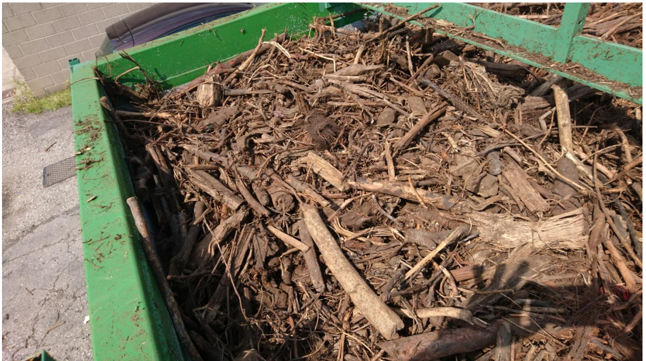
Figura 4.9. Exemple de biofiltre containere cu material organic (detaliu). Sursa: ASWM Srl, 2021.
