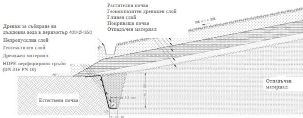
Фигура 5. Мрежа за събиране на метеорна вода - Басейн 1. Източник: Donini A., Pelonghini L., ed. 1998,2004 г., Извършени геолого-геотехнически доклади по повод проектите за изграждане на инфилтратната лагуна и резервоарното езеро
