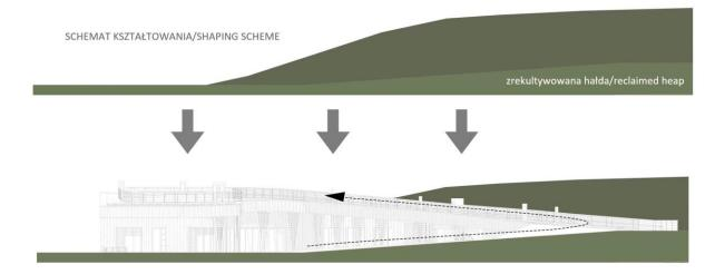
Zielony dach przystosowany do ruchu pieszych, który kształtem wpisuje się do zrekultywowanej hałdy The green roof is adapted to pedestrian traffic and its shape fits into the reclaimed heap
