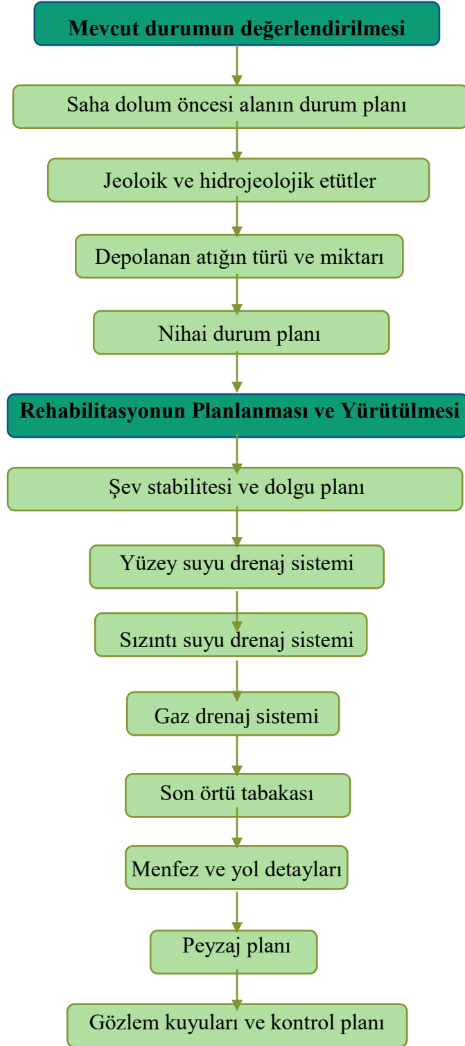
Şekil 3.1. Yerinde rehabilitasyon akım şeması.
