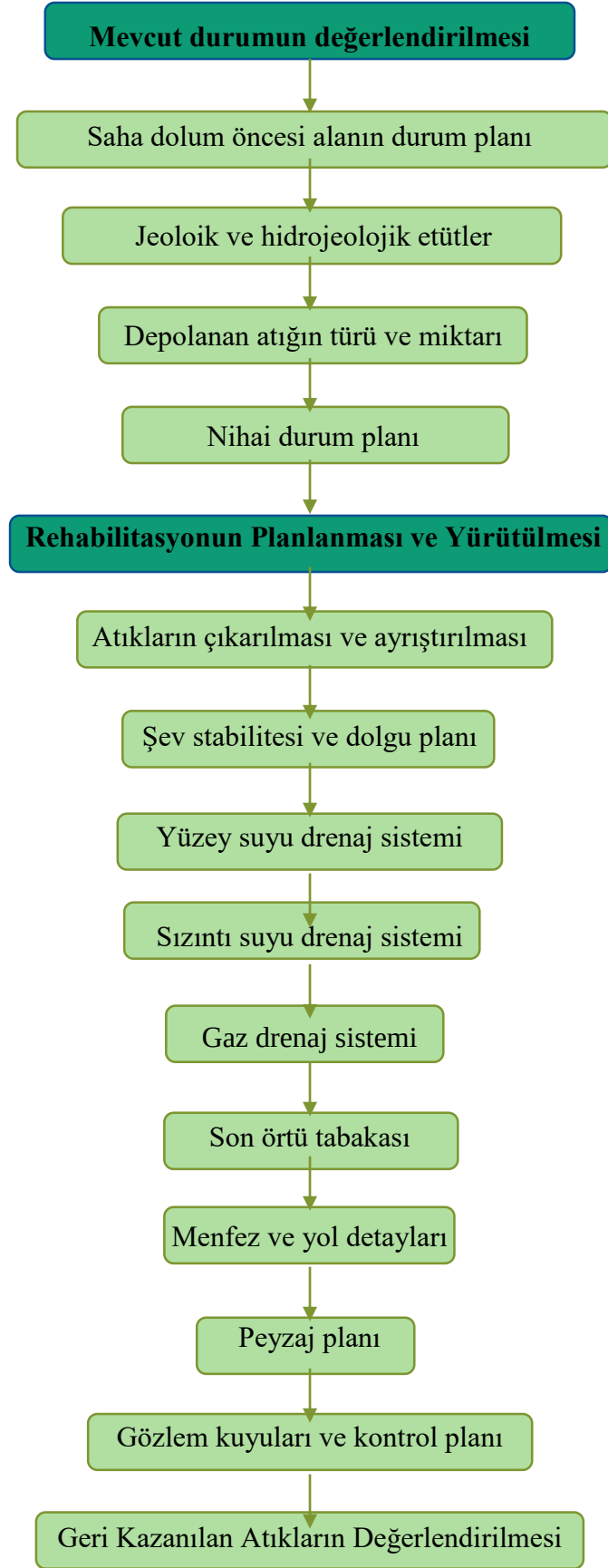
Şekil 3.3. Geri dönüştürülebilir atıkların mekanik ayrırımı sonrası rehabilitasyon akım şeması.
