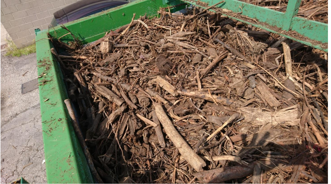
Şekil 4.9. Konteynerde organik madde içeren biyofiltre örnekleri (detay). Kaynak: ASWM Srl, 2021.
