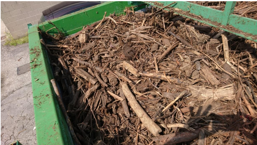
Фигура 4.9. Примери за контейнерни биофилтри с органичен материал (подробно).
