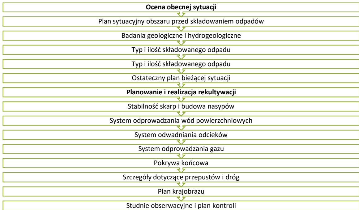
Rysunek 3.1. Schemat rekultywacji in-situ.
