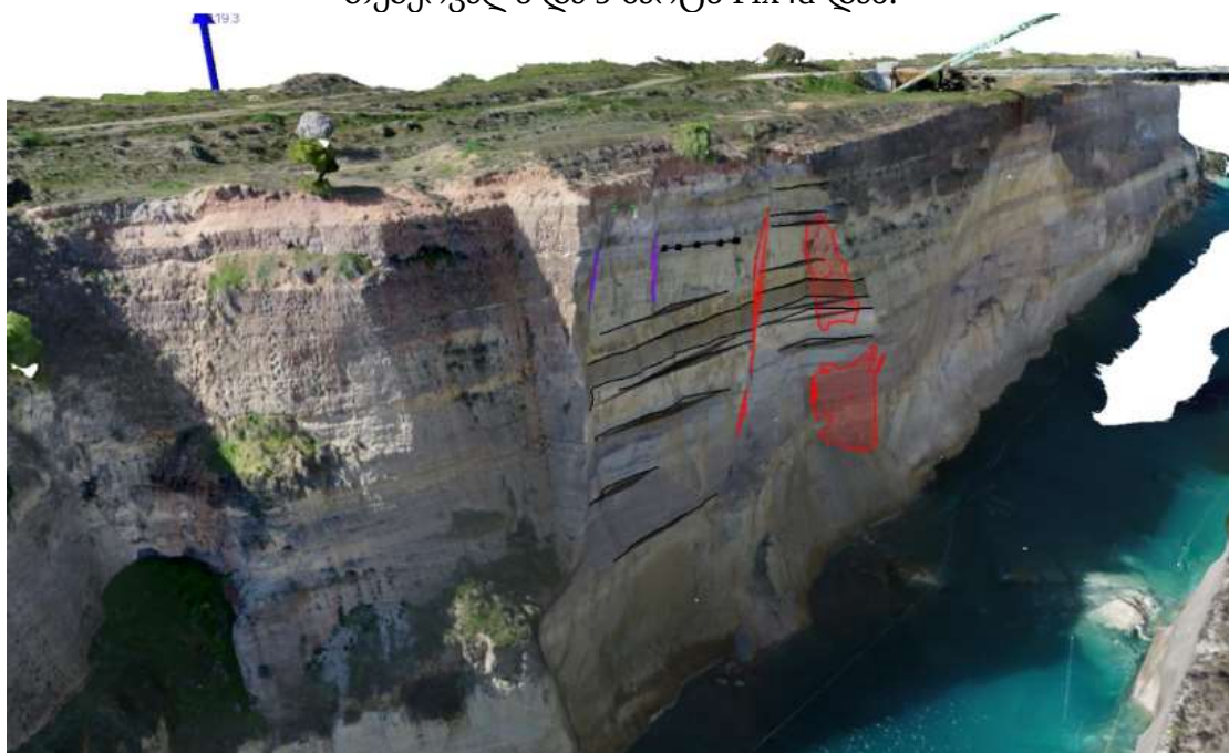
სურათი 3.24. 3D მოდელი ShapeMetriX უპილოტო საფრენი აპარატიდან, რომელიც ასახავს ხარვეზებს და ძირითად უწყვეტ ზედაპირებს, რომლებიც აკონტროლებენ 26 თებერვლის ფერდობის უკმარისობას (რღვევის ზედაპირები წითელში, სახსრის ზედაპირები ლურჯში, საწოლების ზედაპირები შავში).
