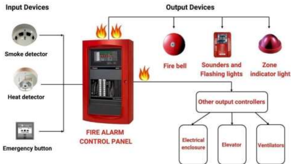
სურათი 4.7. ხანძარსაწინააღმდეგო სიგნალიზაციის მართვის პანელი.
