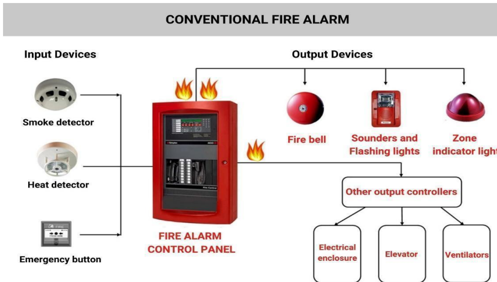
Εικόνα 4.7. Πίνακας Ελέγχου Συναγερμού Πυρκαγιάς
