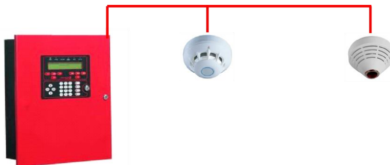
Εικόνα 4.6. Πίνακας και ανιχνευτής καπνού
