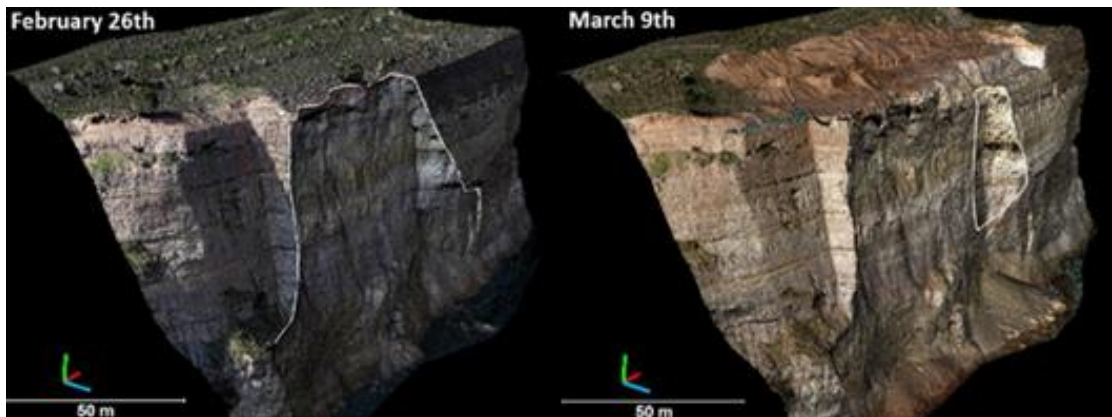
Şekil 3.23. 26 Şubat ve 9 Mart tarihlerinde Pix4d ile çekilerek oluşturulan ve Korinth Kanalı'ndaki şev kaymasını gösteren nokta bulutu.
