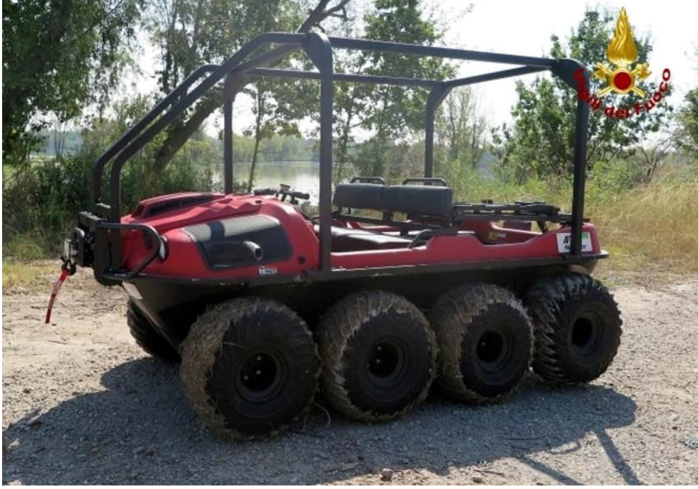
Şekil 5.27. Taşkınlarda kurtarma operasyonları için kullanılan özel araç.
